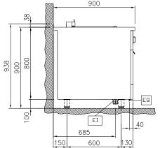
Electrical inlet (power) Equipotential screw
